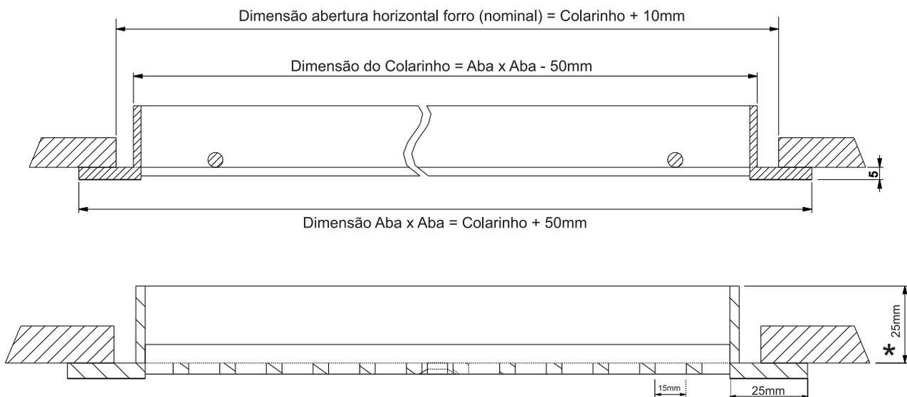
\*OBS: GCD-D, Altura do colarinho altera para 45mm
